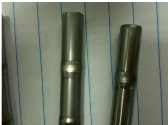
de la guia K-Line pero la empuje para fuera de la guia. En el peor de los casos el expansor este tan aspero que este raya la guia internamente causando que la guia K-Line se convierte en una superficie aspera y desgastante para el vastago de la valvula, causando desgaste prematuro del mismo.
